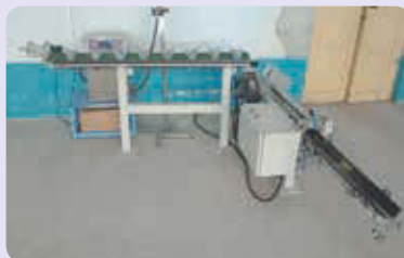
改造後的寶塔紙管自動噴碼機
