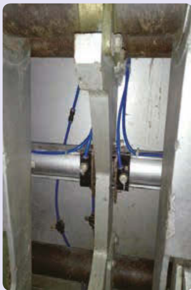
改造後的漿紗機托臂左右移動自動化裝置
